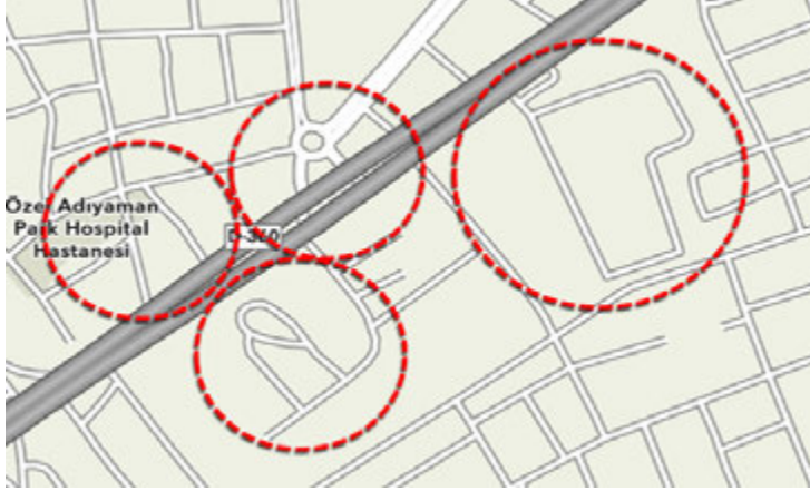
Şekil 3-32 Standartlara Uygun Olmayan Yol Bağlantı Örnekleri
