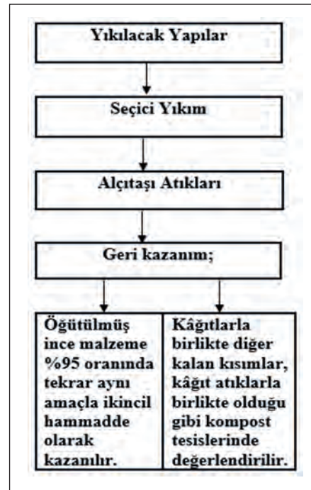
Şekil 12: Alçıtaşı Atıklarının Geri Dönüşümü ve Döngüsel Sıfır Atık Süreci
