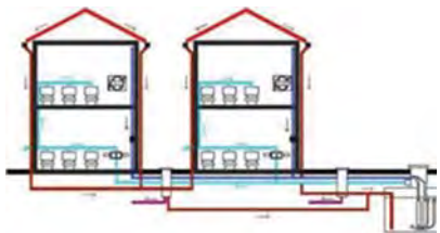
Şekil 3. Ticari binalarda yağmur suyu toplama sistemleri (Şahin, 2010).
