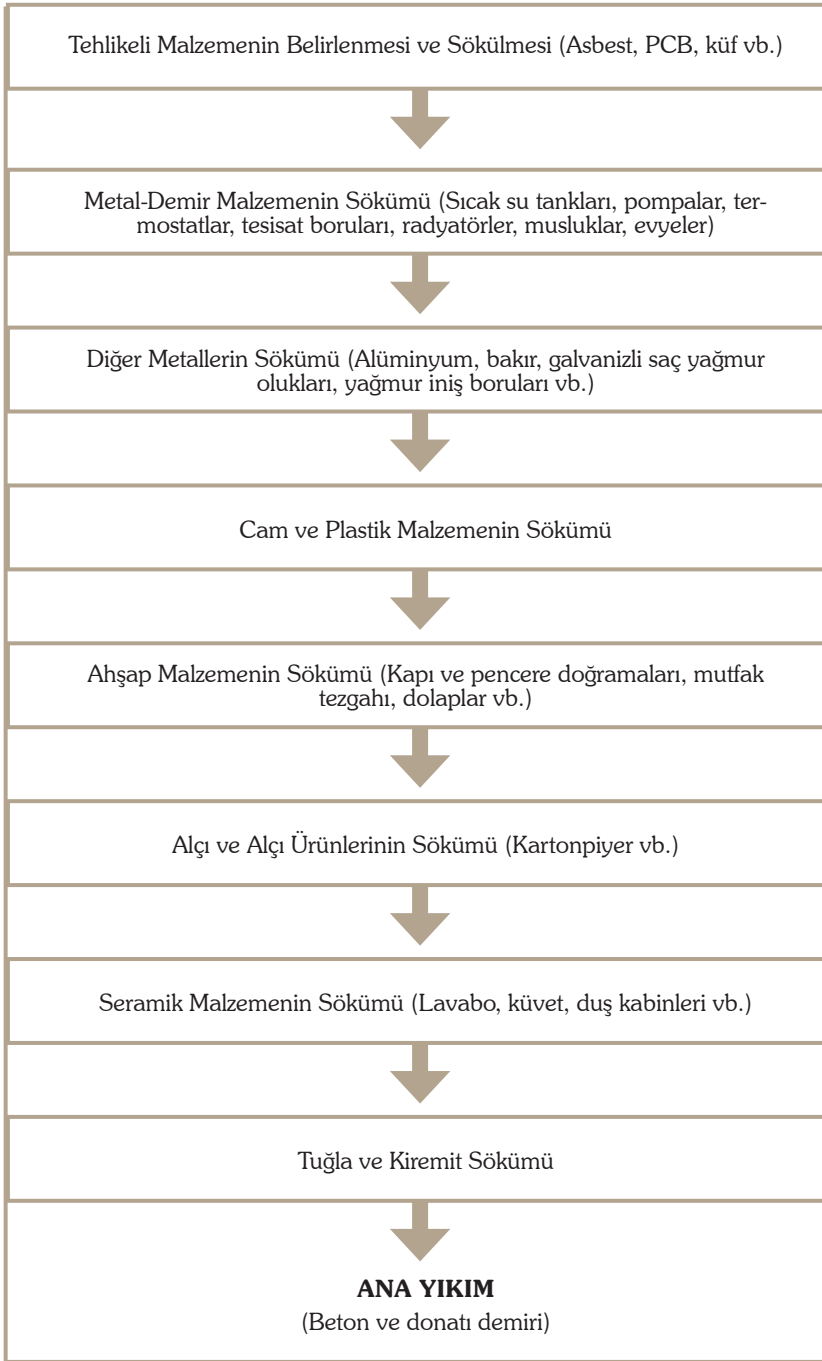
Şekil 1: Seçici yıkım söküm aşamaları
